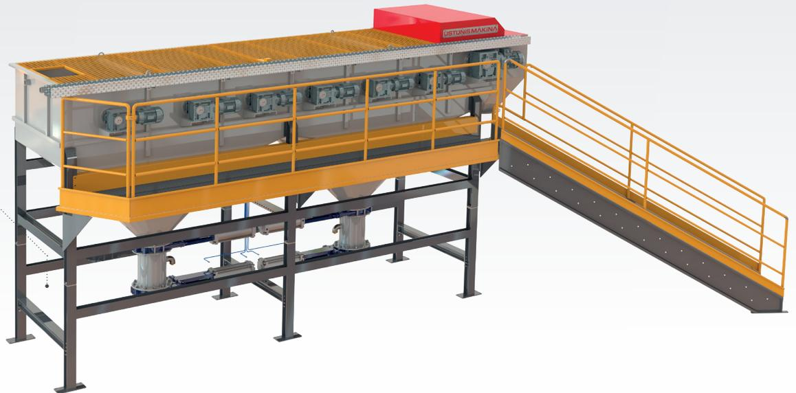
Ванна флотации предназначена для удаления загрязнений и промывки материала. Тип Ванны флотации выбирается в зависимости от степени загрязнения и вида пластика. Ванна флотации для плавающих полимеров передает материалы которые остаются на поверхности воды, а Ванна для тонущих полимеров передает материалы на следующий этап переработки посредством винта шнека.
