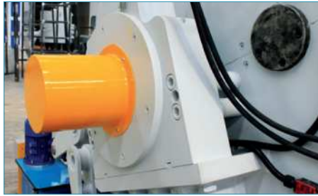
Kırma haznesi dışında yataklanmış, su soğutmalı rulmanlar Water cooled bearings, insulated from grinding chamber
