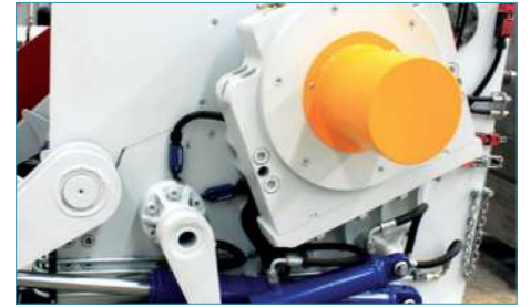
Hidrolik üst gövde ve elek desteği hareketi Hydraulic hopper and screen basket movement
