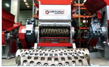
Farklı plastik formlarına uygun rotor tasarımı Rotor design for different forms of plastic
