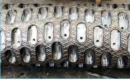
Rotor yüzeyi aşınma önleyici koruma Wear protection for rotor
